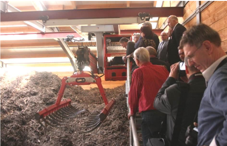
Aufbereitung von Baum- und Strauchschnitt für die Heizzentrale
