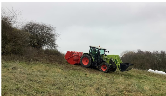
Mulchgerät mit Auffangbehälter im Nachpflege-Einsatz
